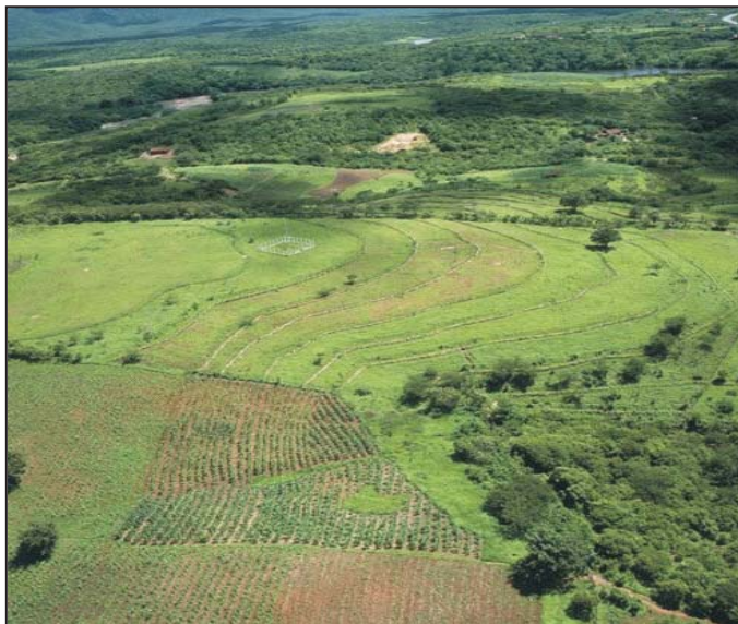
Foto 11 – Visão Aérea de Plantios em Curva de Nível Associados a Cordões de Pedra em Contorno
