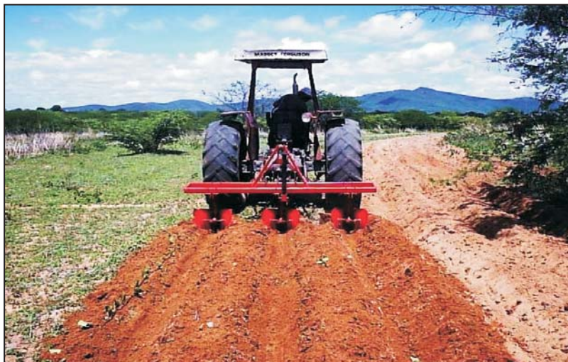
Foto 7 – Sulcamento com Sulcador de 3 Linhas
